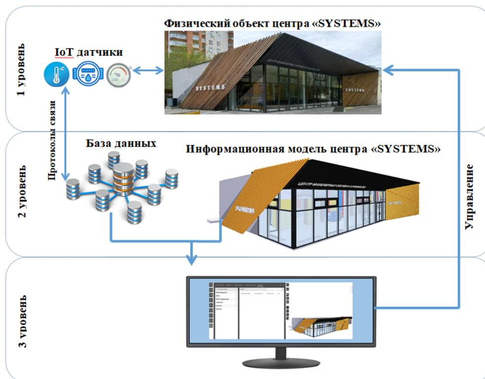
Рис.2. Концепция цифрового двойника здания на примере центра SYSTEMS
